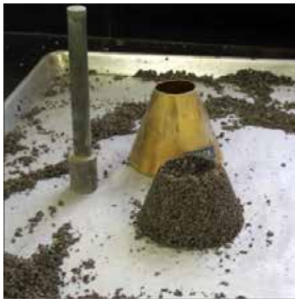
Mynd 1: Mæling á mettvatni í sandi. Sandurinn er talinn „mettaður yfirboðsþurrt“ þegar rakinn er ekki lengur nægjanlegur til að halda keilunni saman og keilan „skríður“.
