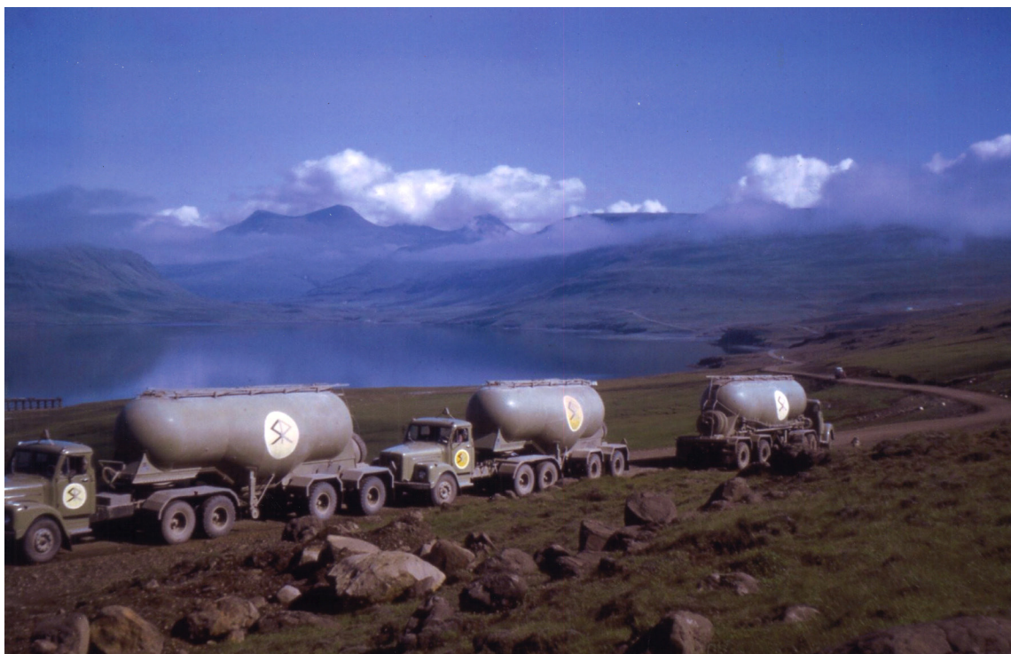
Fyrstu þrír sementsflutningabílar Sementsverksmiðju ríkisins við Hvítanes í Hvalfirði. Scania Vabis L 76 Super, árgæð 1967, tveggja drifa, 260 hestöfl.
