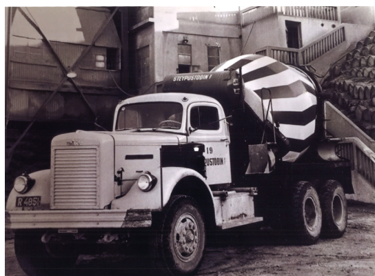
Fyrstu þrír sementsflutningabílar Sementsverksmiðju ríkisins við Hvítanes í Hvalfirði. Scania Vabis L 76 Super, árgæð 1967, tveggja drifa, 260 hestöfl.
