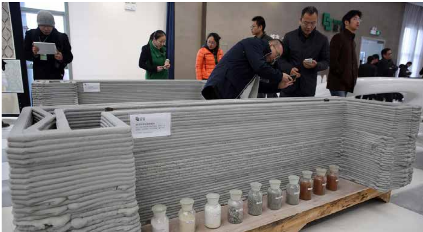
3D prentaðar einingar í kínversk smáhýsi. mynd af heimasíðu techinasia.com
