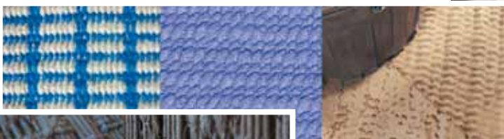
Mynd 8. Stefnumót textíls og steypu. Yfirborð steypunnar með áferð textílsins. Textíllinn var unninn af nemendum MÍR.
