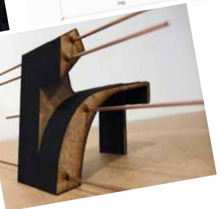
Mynd 5: Ljósmynd af líkani 1:10. Sýnir hvernig líkanið er byggt úr mörgum sneiðingum.
