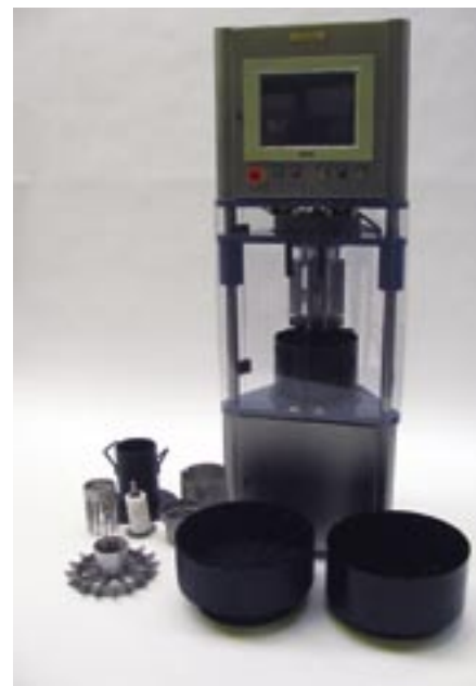
Seigjumalar fyrir steypu leika lykhlutverk í flotfræðimælingum. Hér er eitt þeirra rannsóknartækja sem Ólafur hefur hannað.
