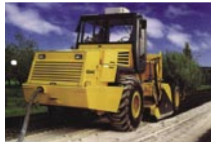
Jarðvegstætariinn sem notaður var við sementsfestuna í Langadal árið 1996 (Heimild: kynningarrit frá fyrirtækinu Bomag ).
