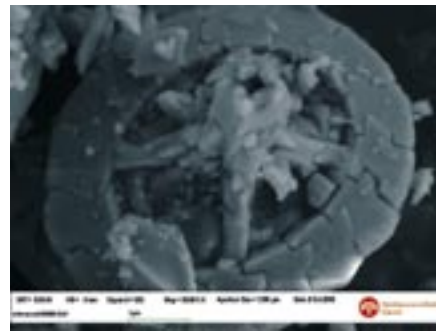
Eins og þessi mynd sýnir innihéldu sum sementssýnin steingerða svifþörungur er kallast coccolithophorids sem (komust væntanlega í sementið sem hluti af kalksteini)
