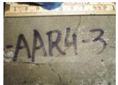
Sprungur vegna alkalívirkni í AAR-4 steypustrendingi eftir geymslu í 10 vikur við 60°C.
